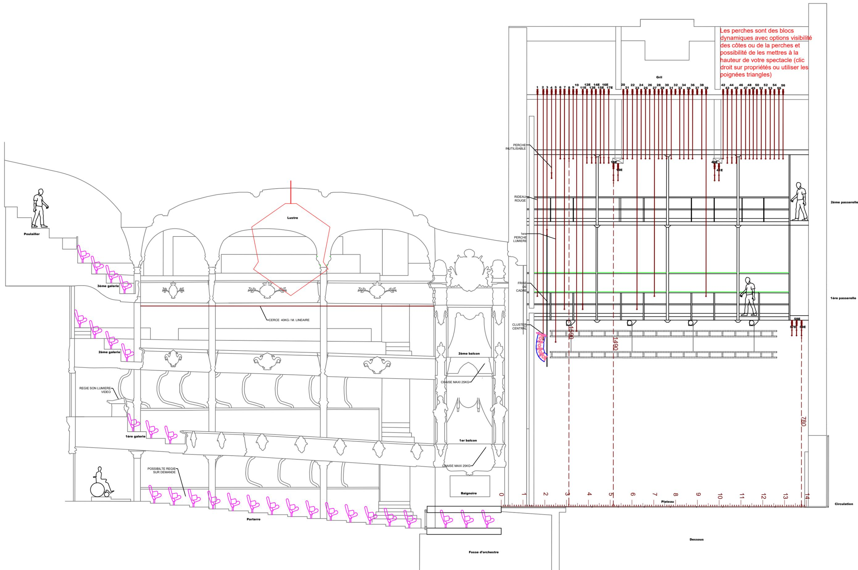
Les perches sont des blocs dynamiques avec options visibilité des côtes ou de la perches et possibilité de les mettre à la hauteur de votre spectacle (clic droit sur propriétés ou utiliser les poignées triangles)
