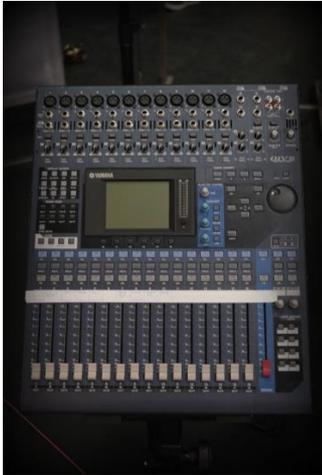
La table de mixage permet de mélanger les sons et de les transformer en ajoutant de la résonance, des échos ou d'autres effets spéciaux.
